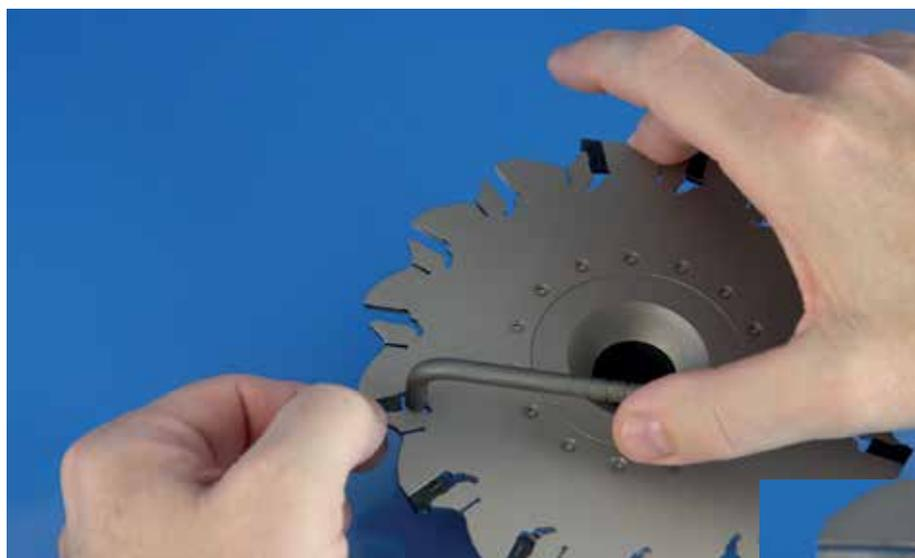
Montageschlüssel TMA-10 in die vorgesehene Nut einstecken (Bild 3) und gegen den Uhrzeigersinn **vorsichtig** drehen, bis sich die Schneidplatte mit 2 Fingern entnehmen lässt. Überdrehung vermeiden, da sonst der Plattensitz zerstört wird.
