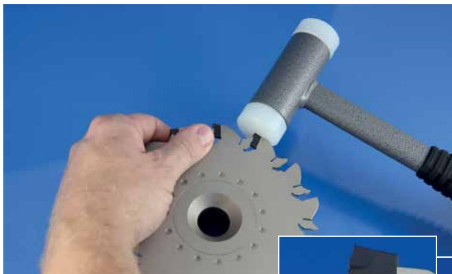
Schneidplatten per Hand in den Plattensitz einlegen (Bild 1) und mit dem Kunststoffhammer durch einen leichten Schlag positionieren (Bild 2).
